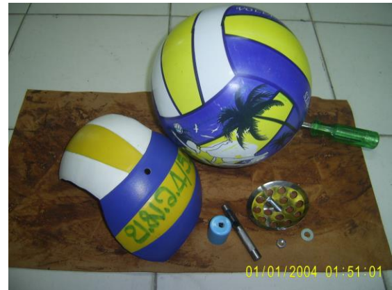
ตัดลูกวอลเลย์บอลแล้วเจาะด้วยตาไก่
